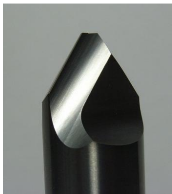
超硬溝入れバイト製作 0.2t × 0.35 × φ4 (展示品6)
