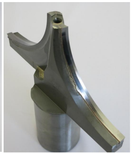
超硬ロー付コーナーRカッター製作 φ150 × R60 × φ40
