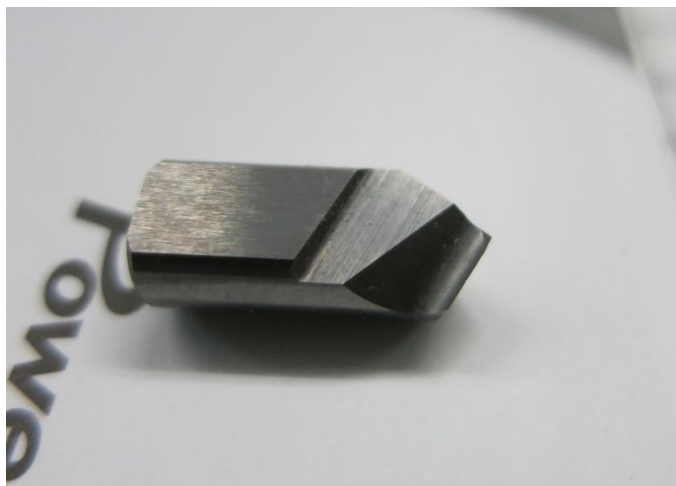
超硬ボーリングバイト製作 \phi 8 \times 18 \times 55^\circ
