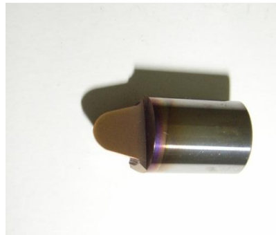
超硬ネジ切りチップ製作 φ8 SX-Wコート
