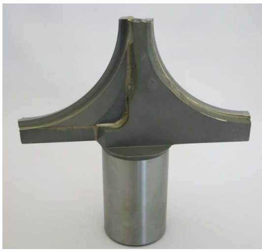
超硬ロー付コーナーRカッター製作 φ150 × R60 × φ40
