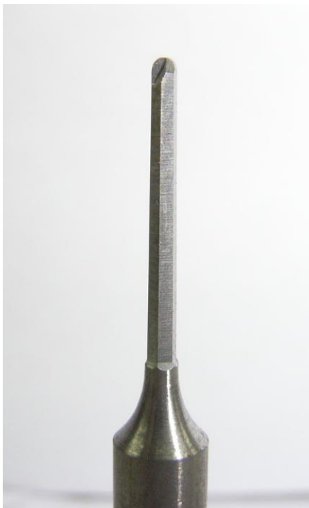
超硬総型カッター製作 φ20 × 120L
